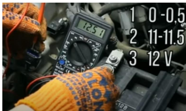
Рисунок 3.4 – Вихідні і вхідні сигнали давача фаз бензинового двигуна.
