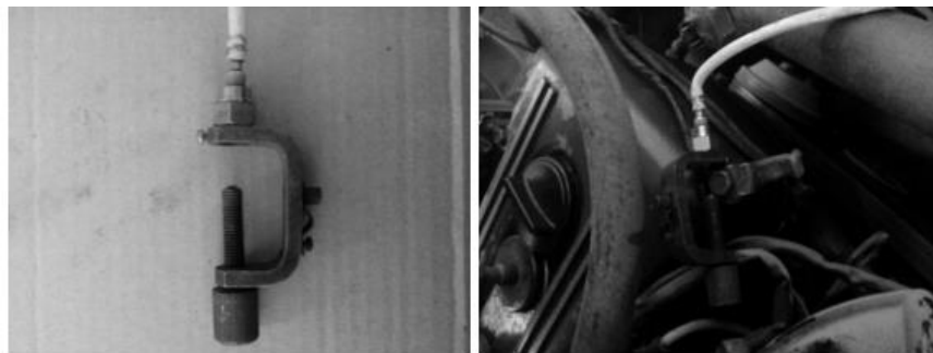
Рисунок 3.2 – П'єзодавач для вимірювання вібрації у місці розміщення ГРМ двигуна.
