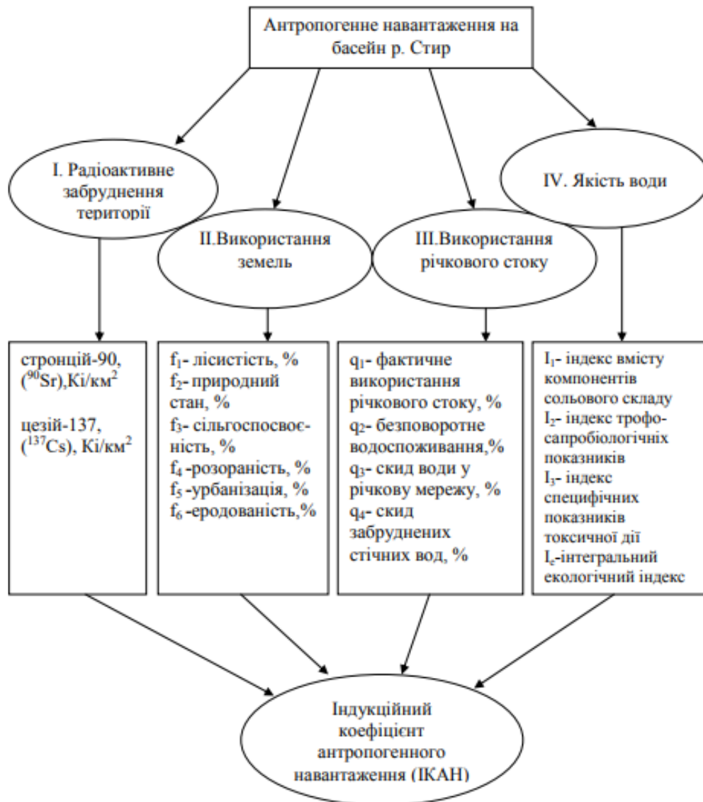
Рисунок 2.9 – Алгоритм визначення антропогенного навантаження в басейні річки [42]
