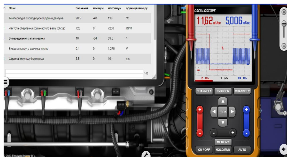
Рисунок 3.6 – Результати досліджень паливних форсунок системи Motronic.
