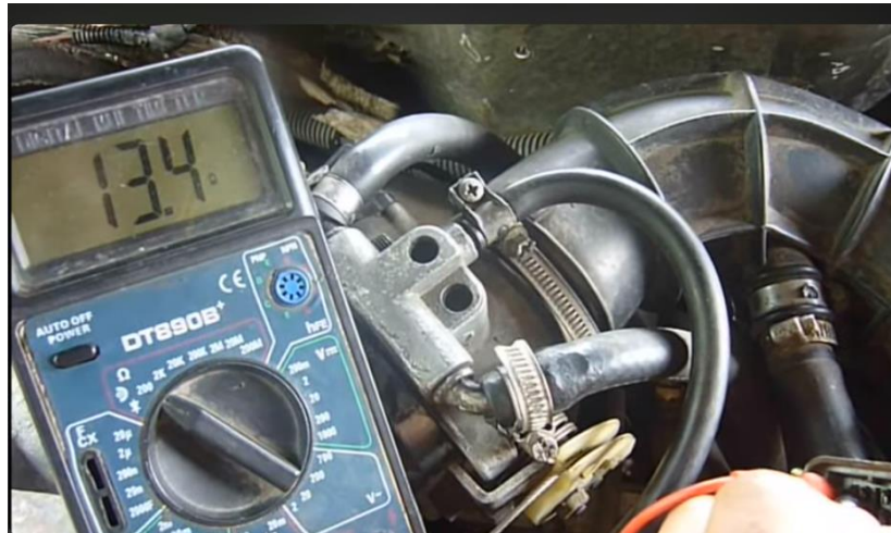
Рисунок 3.4 – Визначення опору обмотки електромагнітного клапана.
