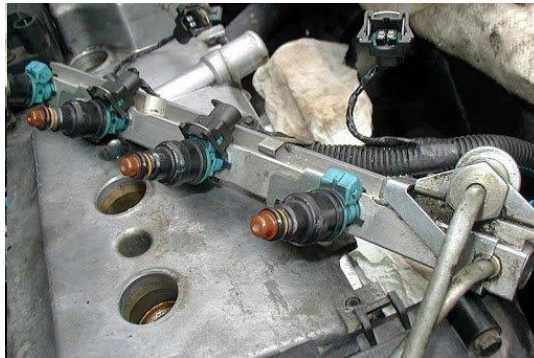
Рисунок 3.5 – Перевірка електромагнітних форсунок, встановлених на рампу.
