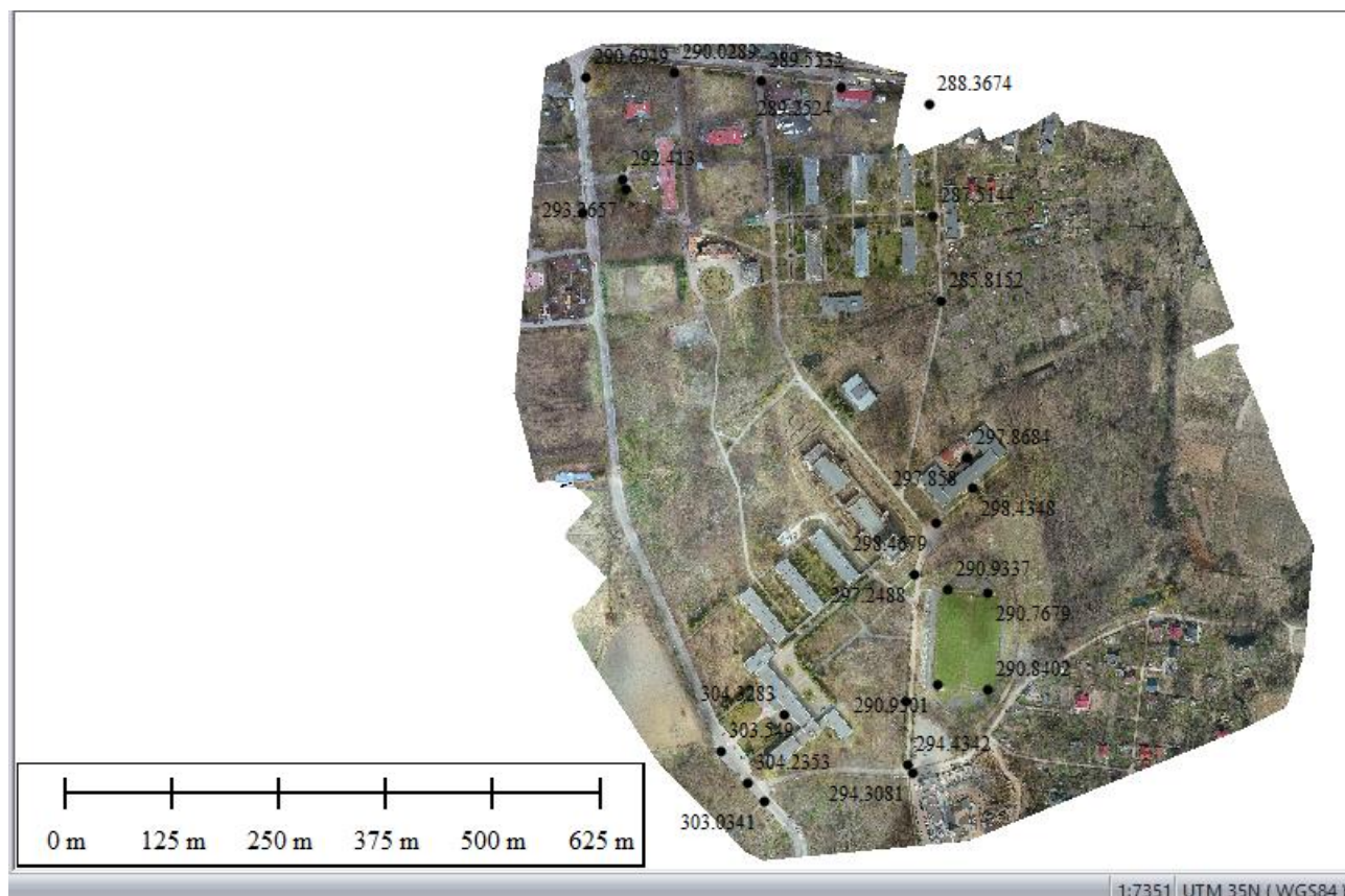
Рис.3.10. Результати опрацювання блоку аерознімків: Цифрова модель рельєфу та ортофотоплан на територію ЛНУП
