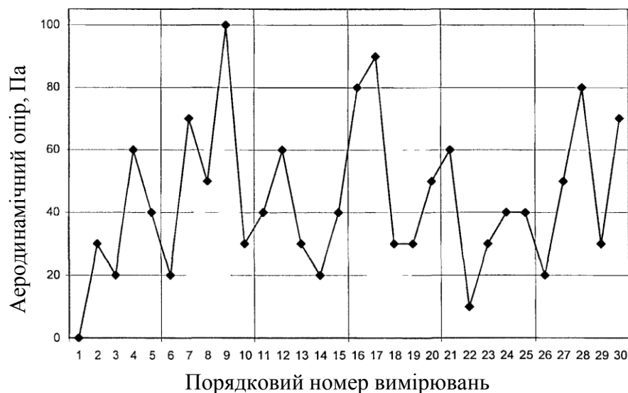
Рисунок 4.3 – Графічне представлення даних додаткового аеродинамічного опору, отриманих під час проведення експериментальних досліджень радіаторів з напрацюванням
