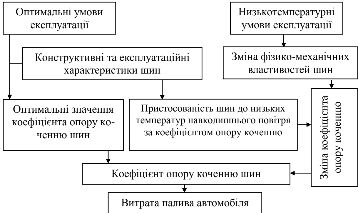
Рисунок 2.1. Схема формування витрати палива автомобіля під впливом характеристик використовуваних шин за низькотемпературних умов експлуатації
