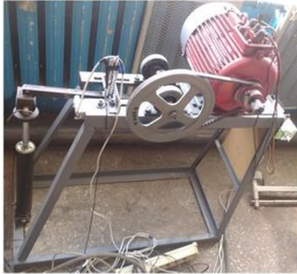
Рисунок 3.2 – Лабораторна установка для визначення експлуатаційних характеристик амортизаторів
