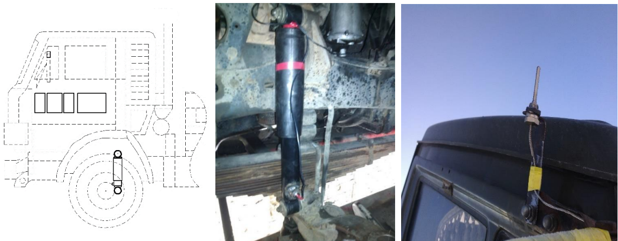
Рисунок 3.1 – Експериментальна установка на базі автомобіля КрАЗ-5401С2-500 із встановленими датчиками контролю температури амортизаторної рідини і температури навколишнього повітря
