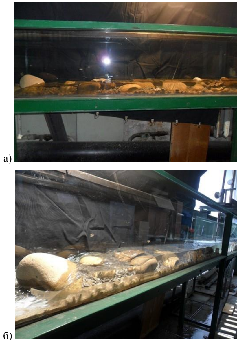
Рис. 4.37. Візуалізація потоку води за моделювання течії через пороги та перекати: а) Q_3 = 0,0012 \text{ м}^3/\text{с} ; б) Q_4 = 0,0018 \text{ м}^3/\text{с}
