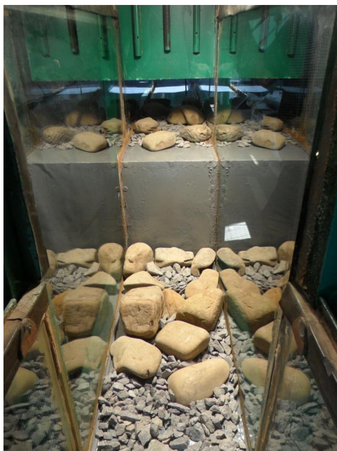
Рис. 2.5. Ділянка для моделювання течії води через водоспади та пороги: а) вид збоку; б) вид зі сторони мірної ділянки
