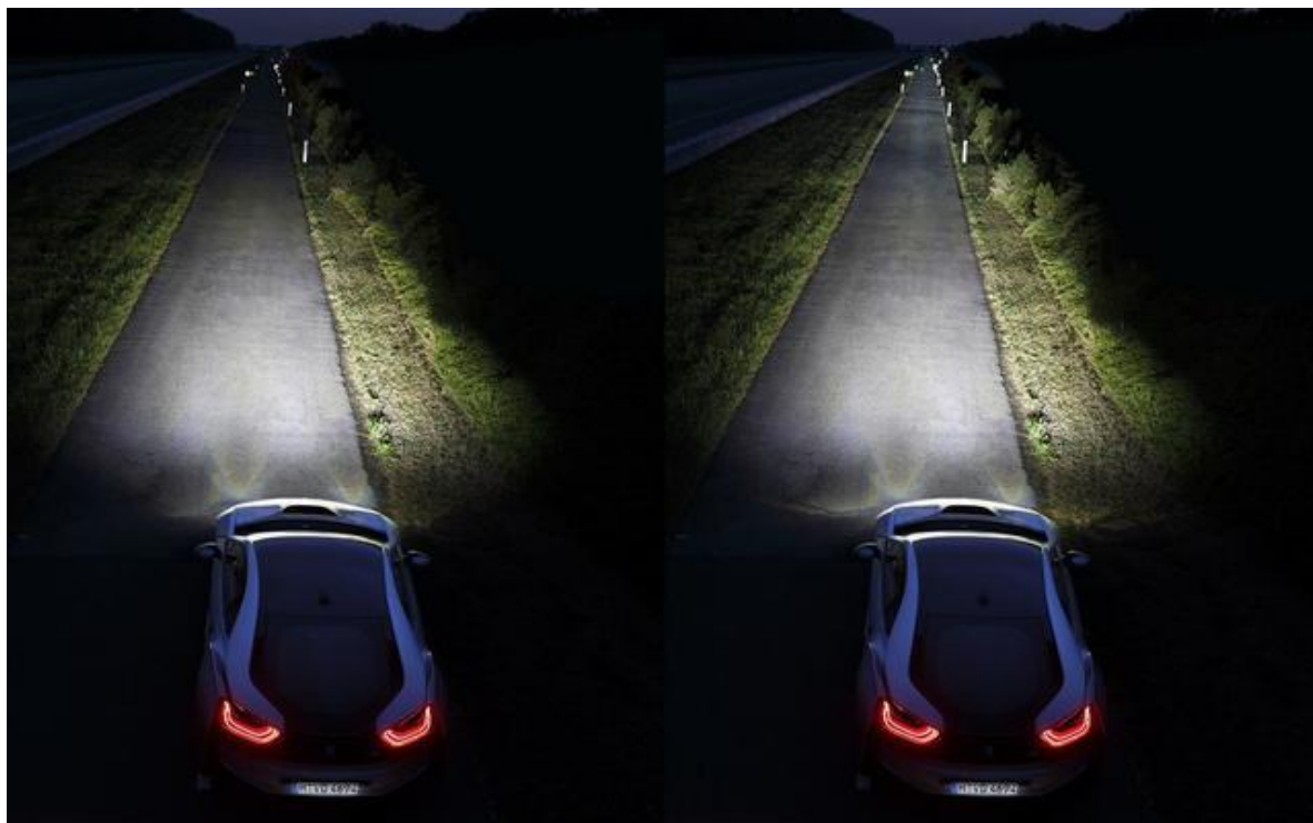
Рисунок 3– Різниця освітлення ближніх фар з дальніми
