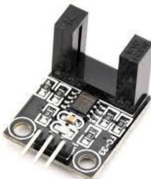
Рисунок 28 - Модуль фотоімпульсного датчика швидкості двигуна
