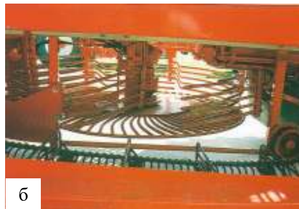
Рисунок 2.Б4.2 – Конструктивна схема (а) та загальний вигляд (б) однороторного очисника: 1 – рама; 2 – очисний ротор; 3 – обмежуючі направляючі решітки; 4 – редуктор приводу
