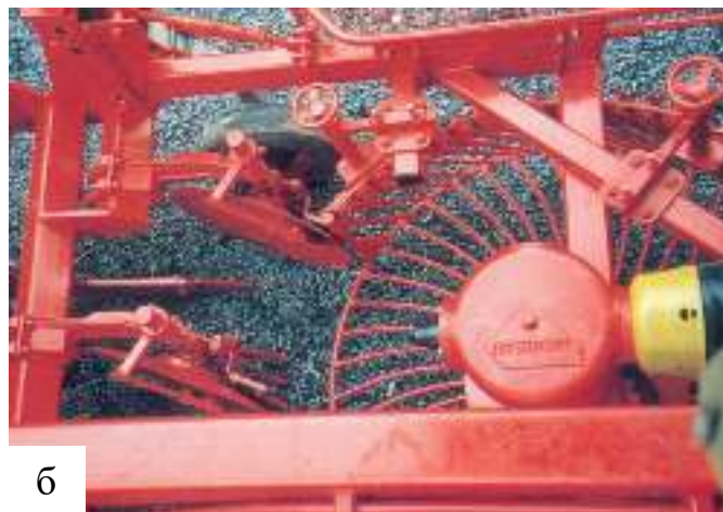
Рисунок 1.Б4.2 – Конструктивна схема (а) та загальний вигляд (б) копача коренеплодів з роторним очисником: 1 - лемішні копачі; 2, 5 – решітні роторні диски; 3 – утворений валок коренеплодів; 4 – гвинт
