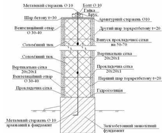
Рис. 3.14. Конструкція торкретованої стіни з соломи [Пат. Мазурак А.В.].
