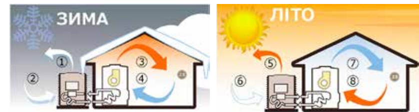
Рис.4.10. Принцип роботи теплового насоса у зимовий та літній періоди [Тепловые насосы]
