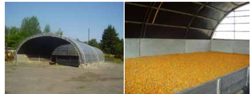
Рис. 4.4. Сушарки для врожаю: зліва – загальний вигляд; справа – сушильна секція з технологічним матеріалом [Сушарка]
